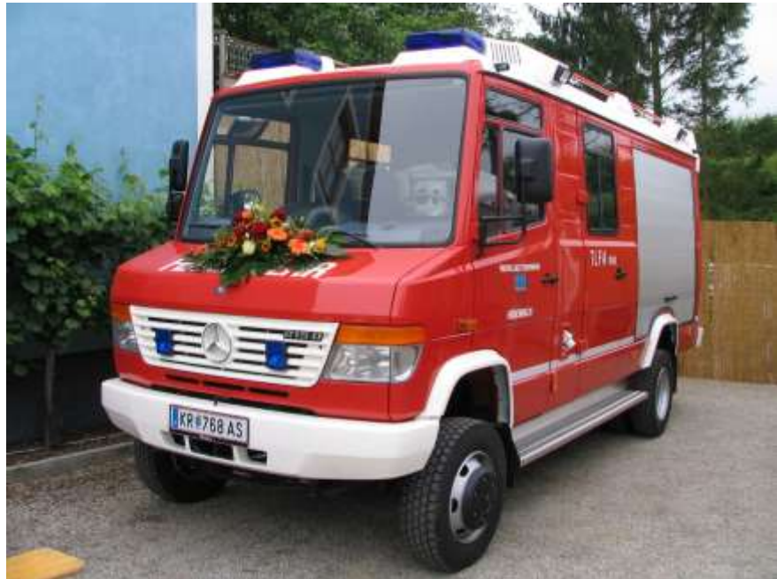
Unser neues Einsatzfahrzeug – Mercedes Vario 815 mit Allrad, mit 1000 lt Wassertank und Hochdruck-Einbaupumpe (TLFA-1000)
